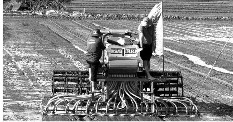
● Máy gieo sạ kết hợp với phân phát huy hiệu quả giảm giống, phân và thuốc BVTV.
