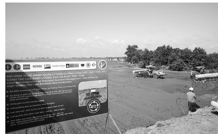
● Máy gieo sạ khí động kết hợp vùi phân tại mô hình vùng liên kết ở xã Phương Thịnh. (Ảnh: Lê Sơn)
